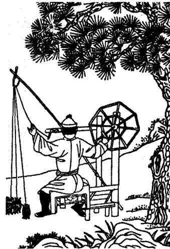
Станок для намотки нитей на шпулю (с книжной гравюры)
