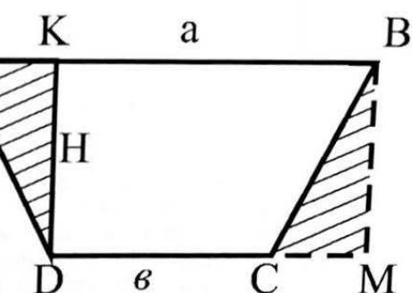
Рис. 47. Вычисление объема рва как объема тела вращения (трапеции ABCD) вокруг фиксированной точки.
