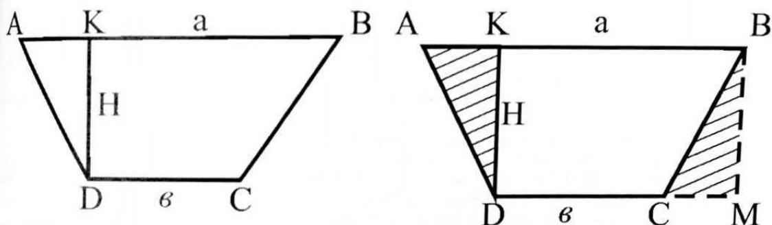
Рис. 46. Геометрическая схема сечения рва.
